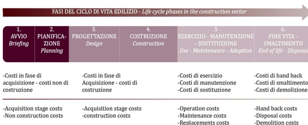
Fig. 2 Articolazione delle macro-voci di costo aggregate lungo le fasi del ciclo di vita edilizio
